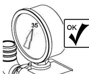
Il calo della pressione all' apertura delle mandate è dovuto al principio idraulico di funzionamento delle valvole
